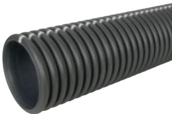
Teilsicker-, Vollsicker- und Mehrzweckrohre aus PE-HD nach DIN 4262-1, Typ R2, Wassereintrittsfläche  $\geq 50 \text{ cm}^2/\text{m}$  für LP, TP, MP, Schlitzbreite  $1,2 \text{ mm} \pm 0,4 \text{ mm}$ . Entsprechend RAS-Ew (Richtlinien für die Anlage von Straßen, Teil: Entwässerung) einsetzbar (SN 4 nach DIN EN ISO 9969). Rohr-Sonderfertigungen auf Anfrage lieferbar.
