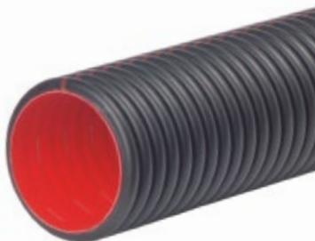
Teilsicker-, Vollsicker- und Mehrzweckrohr SN 16 aus PP in bewährter Verbundrohrbauweise (außen gewellt, innen glatt), gemäß DIN 4262-1 Typ R2 und DIN 13476. Erfüllt die speziellen Anforderungen der DBS 918064 der Deutschen Bahn AG. Besitzt die Herstellerbezogene Produktqualifikation (HPQ).
