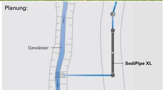
vorhandener Regenwasserkanal mit SediPipe-Vorreinigung
