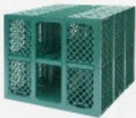
Das Herzstück der Regenwassernutzung. In diesen unterirdisch zu verbauenden Rigolen-Füllkörpern wird das Regenwasser gesammelt und bevorratet. Sie bilden mit 95 % Hohlraumvolumen einen sehr effizienten Wasserspeicher, mit dem aufgrund seiner modularen Bauweise praktisch jede beliebige Anlagengeometrie realisiert werden kann. Weitere Informationen siehe Seite 76 bzw. 133.
