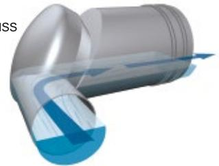
Der große Ablaufquerschnitt sorgt bis zum Bemessungsabfluss für eine schnelle Entleerung
