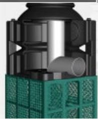
Überlaufschacht (Grundfläche 800 x 800 mm, Höhe 350 mm oder 660 mm) für Regenrückhaltanlagen in RigoCollect-Bauweise zur Limitierung des maximalen Wasserspiegels. Am Rigolenrand frei platzierbar. Bei mehrlagigen Anlagen Anordnung in der obersten Lage Rigofill inspect. Ablaufdurchmesser DN 200 KG. Weitere Informationen siehe Seite 105 bzw. 146.
