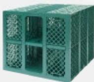
Das Herzstück der Regenwasserrückhaltung. In diesen unterirdisch zu verbauenden Rigolen-Füllkörpern wird das Regenwasser zurückgehalten. Sie bilden mit 95 % Hohlraumvolumen einen sehr effizienten Wasserspeicher, mit dem aufgrund seiner modularen Bauweise praktisch jede beliebige Anlagengeometrie realisiert werden kann. Weitere Informationen siehe Seite 76 bzw. 133.
