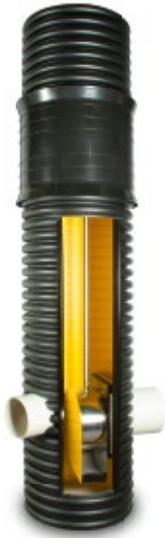
AquaLimit ist ein vielseitig einsetzbarer, anschlussfertiger Drosselschacht  $D_A$  600 aus PP, mit integriertem Edelstahl-Wirbelventil des Herstellers **UFT Umwelt- und Fluid-Technik Dr. Brombach GmbH**. AquaLimit kombiniert starke Abflussleistung mit höchster Betriebssicherheit. Bei der Drosselung mit Wirbelventilen werden keine beweglichen Teile benötigt, wodurch ein
